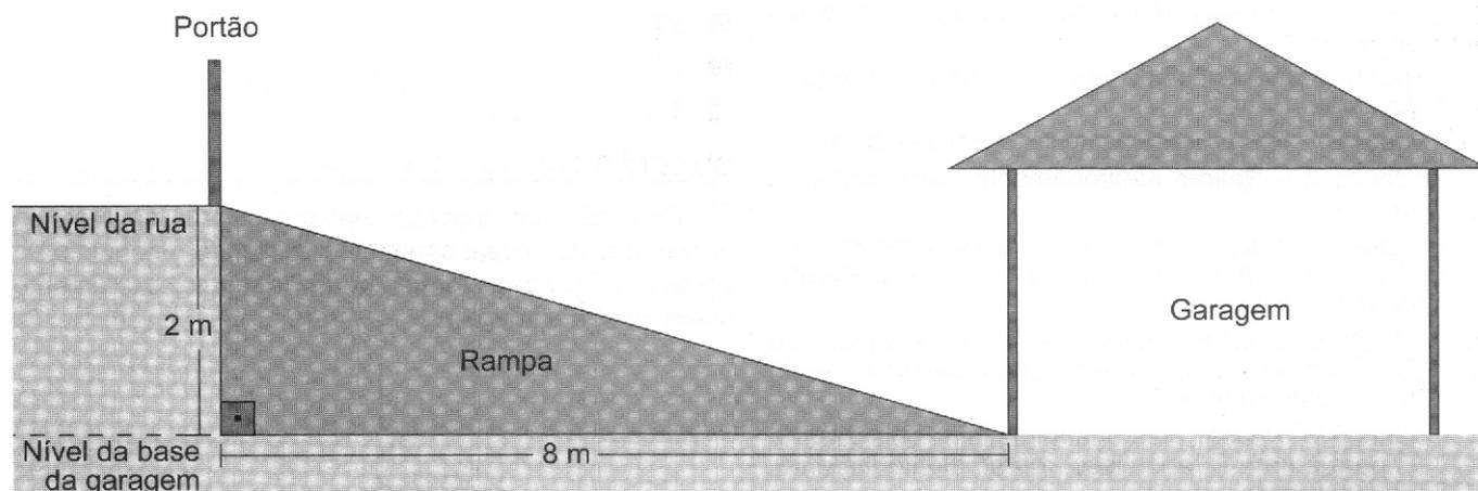
Depois de projetada a rampa, o responsável pela obra foi informado de que as normas técnicas do município onde ela está localizada exigem que a inclinação máxima de uma rampa de acesso a uma garagem residencial seja de 20%.
