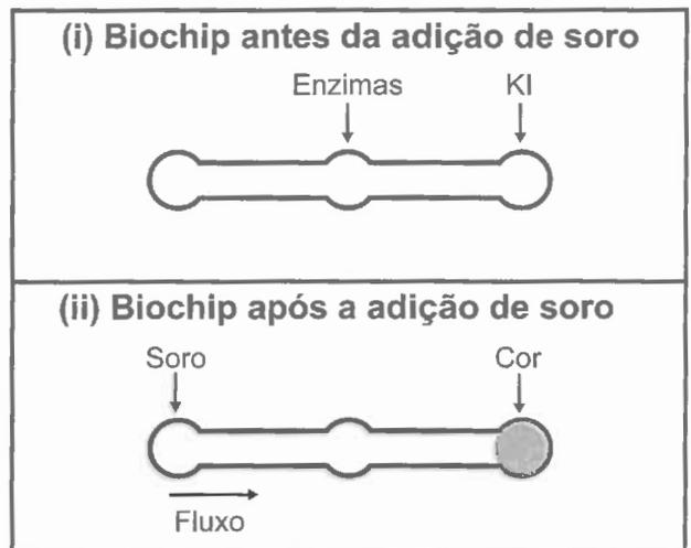
Após a adição de soro sanguíneo, o fluxo desloca-se espontaneamente da esquerda para a direita (ii) promovendo reações sequenciais, conforme as equações 1 e 2. Na primeira, há conversão de glicose do sangue em ácido glucônico, gerando peróxido de hidrogênio:
