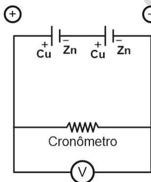
Observa-se que tanto o cronômetro quanto o voltímetro estão em paralelo com o gerador associado.
