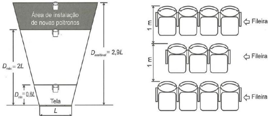
Pretende-se ampliar essa sala, mantendo-se na mesma posição a tela e todas as poltronas já instaladas, ampliando-se ao máximo a sala para os fundos (área de instalação de novas poltronas), respeitando-se o limite aceitável da norma da ABNT. A intenção é aumentar, ao máximo, a quantidade de poltronas da sala, instalando-se novas unidades, iguais às já instaladas.
